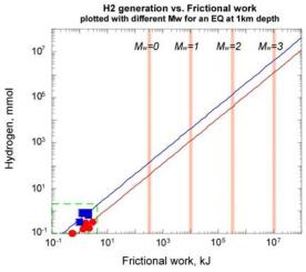
上図:摩擦仕事量と水素発生量の関係.玄武岩を秒速 1.6m で 10m すべらせた実験.青色は水を飽和させた試料.赤色は乾燥岩石試料.水に飽和させた試料の方が水素の発生量が大きい.また,摩擦すべり仕事量が増えるに従って水素量がほぼ線形的に増加する傾向が認められる.
