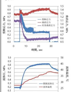
図. 庵治花崗岩を含水条件下で高速すべり (秒速 1.6m) させた時の力学挙動. 流体圧 の増加とともに, 剪断強度が低下していく様 子が確認できる.
