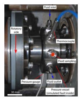
図.世界に先駆けて開発に成功した高速摩擦実験用の小型圧力容器.断層近傍の流体圧と温度も測定することが可能.ただし,空隙率の大きな岩石はこの圧力容器では完全にシールすることができない.今後開発を継続する必要がある.
