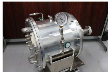
写真4. 偏光測定用ガスチェンバ
