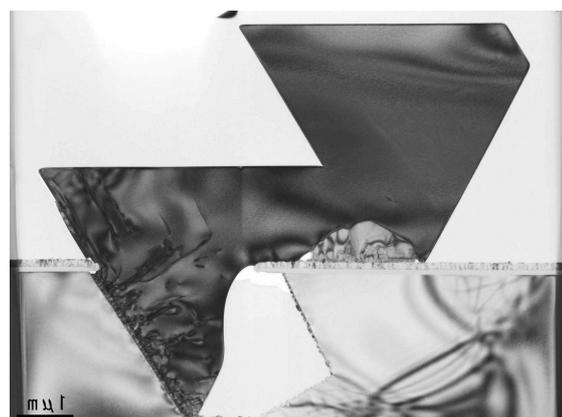
図2 Si基板上(11-22)GaNの2段階成長の断面TEM像
