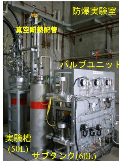
図1 液体水素熱流動実験装置
