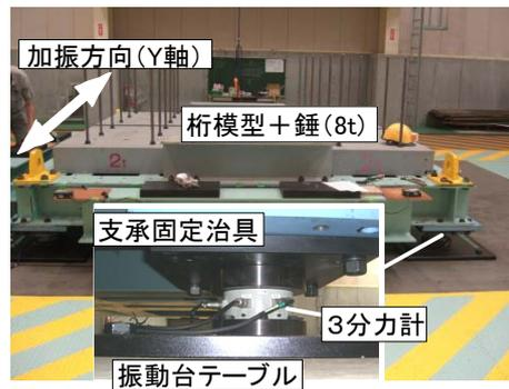
図4 検証実験用試験体の概要
