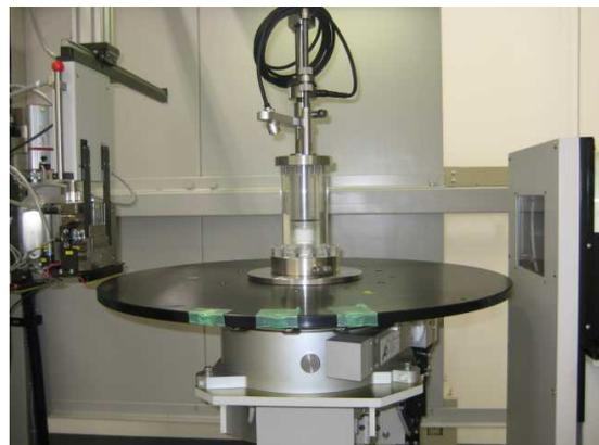
図1 マイクロCTによるベントナイト膨潤試験の様子
