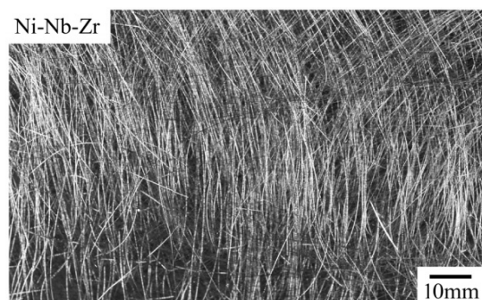
図 2 アーク溶解型溶融抽出紡糸法により作製した Ni-Nb-Zr 溶融抽出紡糸ワイヤー
