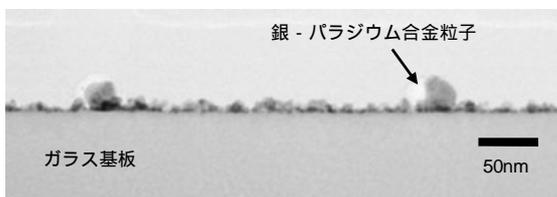
図3 ガラス基板に吸着した銀-パラジウム二元系合金粒子の断面TEM写真
