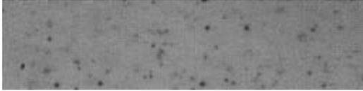
図 2 高速度カメラにより撮影された水滴 (図中黒点が水滴、画像横幅が 5mm に相当)
