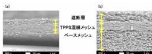
図 3 TPPS 時間差徐放シートの断面 SEM 観察像 遮断層電界紡糸時間 10 min (a)および 20 min (b)で作製した TPPS 時間差徐放シート
