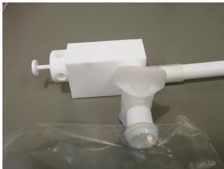
図 1：作成した偏極キセノン吸入用の三方栓、左のノブを動かすことで外部から検査者が吸入路を変化させることができる。
