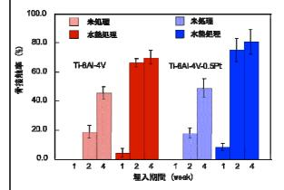
下記の図は Ti-6AI-4V および 0.5Pt を添加した合金の骨結合強度の測定結果を示します。未処理のインプラントの埋入期間が長くなると結合強度は増加しており、 4週目で約 0.5(N/mm²)、白金添加合金では約 1.0(N/mm²)になった。これに対し、処理を行ったインプラントはすべての期間で結合強度は未処理のものより大きくなっており、 4週目で 1.4(N/mm²)に達している。白金を添加した合金については 2週目、4週目で約 1.5(N/mm²)と高い値を示している。
