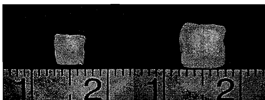
図 1 熱膨張接着材：(左)加熱前、(右)加熱後
