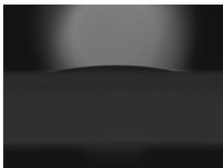
図4 固体 Pt 基板上的の  $\text{Na}_2\text{O-SiO}_2$ 液滴.
