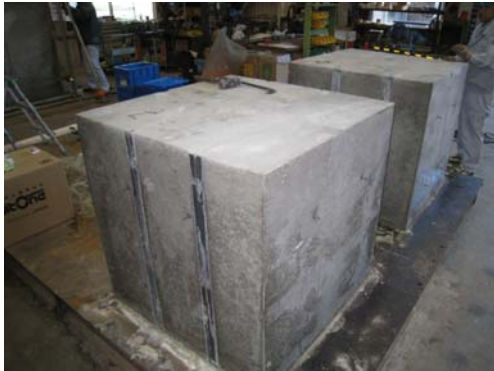
(a) 異なる深さの人工ひび割れを有する立方体
