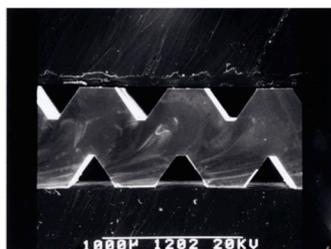
図 4 Si 基板の異方性エッチングによって作製したポンプ可動子
