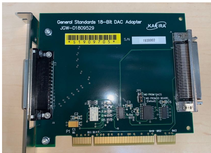
図 2: General Standard 社製の 20 ビットデジタルアナログコンバーターをデータ入出力モジュールで動作させるためのアダプターカード。写真では 18-Bit となっているが、18 ビット(今回は購入していない)および 20 ビットカード両方に使える仕様となっている。
