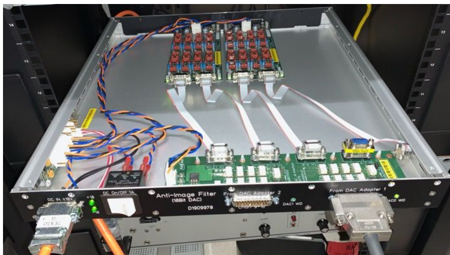
図 3: 製作したアンチイメージフィルター。デジタル信号から発生する高周波の偽信号を除去する。
