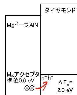
図1 . MgドープAIN/ダイヤモンド異種接合の期待されるバンド概念図
