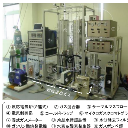
Fig.2 構築したラボスケールの大型構造体触媒反応システム
