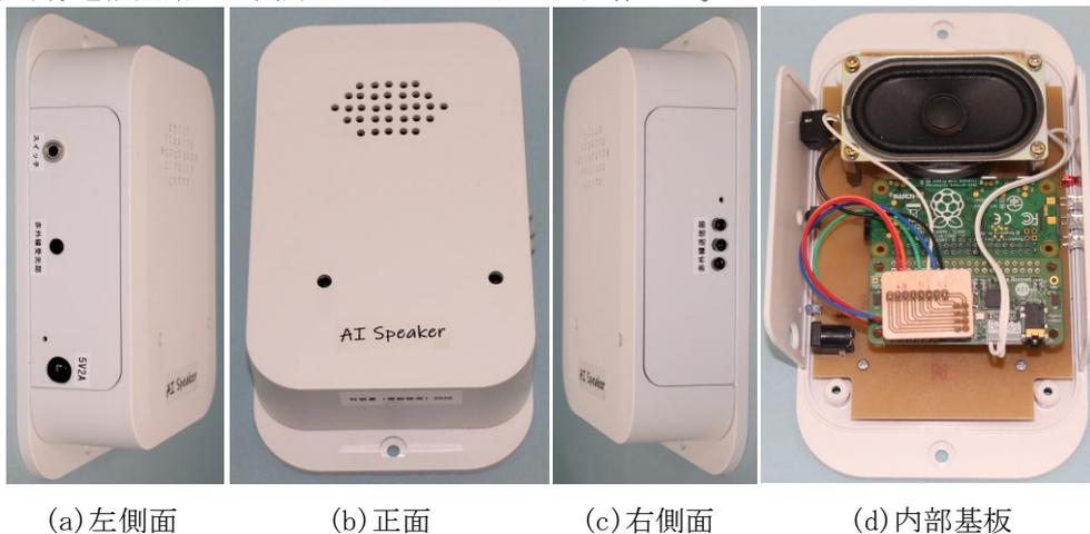
図1 試作AIスピーカー
