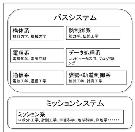
図1. 衛星を構成するシステムと工学的教育的要件
