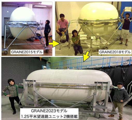
図8: 風船式与圧容器ゴンドラ。望遠鏡を搭載するアルミフレームと圧力を封じ込めるシェル(軽膜材料により製作)等から構成される。球形状(2015年実験)、短シリンダー形状(2018年実験)の開発実績を経て、全長5mシリンダー形状モデルを開発した。
