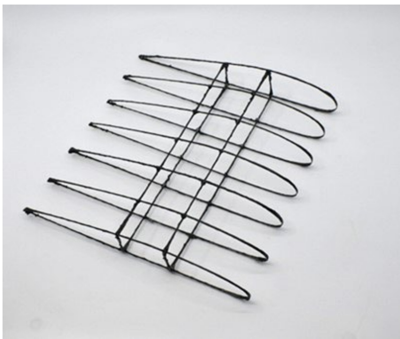
図 3 電着樹脂含浸法を適用して試作したラティス構造の応用例 (無人機翼端部構造)
