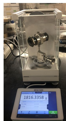
図 2 水素混合系を対象とした飽和密度測定装置ならびに電子天秤を用いた秤量の様子
