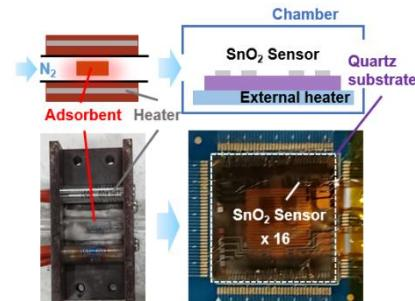
集材に吸着している各分子の脱離温度に応じた温度プロファイルで捕集材の温度を制御することで、低温で脱離する分子から逐次的にセンサアレイに送ることができる。この時間的な熱制御技術に加え、ジュール自己加熱によるセンサアレイの空間的温度制御を組み合わせて分子群識別を試みた。本研究ではジュール自己加熱によりセンサ温度が個別かつ動的に制御可能な  $\text{SnO}_2$  ナノ薄膜横型チャネルセンサデバイスを 1 チップ上に集積化し、16 個同時に温度制御と分子計測を行った。健常者および中枢神経患者の尿を模擬した溶液からの揮発分子群計測の結果、捕集材の時間的熱制御と集積化酸化物センサアレイの空間的熱制御技術を融合することで中枢神経患者の尿が原理的に識別可能であることを示した。今後、呼気をはじめとしたその他の生体ガスや食品からの揮発分子群といった実サンプルの計測・解析に展開し、提案センサシステムによる化学情報の活用につなげる。
