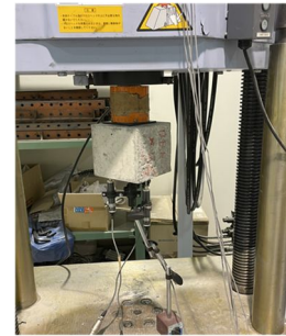
写真-2 鉄筋の付着試験
