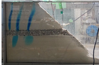
図4 多層斜面地盤の雨水浸透の観察 (左から、単一層傾斜、3層水平、3層傾斜の場合)
