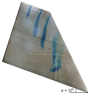
図4 多層斜面地盤の雨水浸透の観察 (左から、単一層傾斜、3層水平、3層傾斜の場合)
