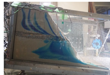
図4 多層斜面地盤の雨水浸透の観察 (左から、単一層傾斜、3層水平、3層傾斜の場合)
