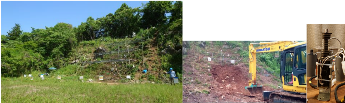
図5 実斜面の崩壊実験（左から、人工降雨実験、堀削実験、弾性波の発振器）
