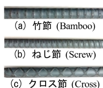
図1 鉄筋の表面形状
