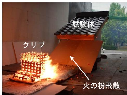
図1 飛び火実験風景
