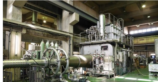
図 3 : 本実験で使用した JAXA 調布風洞センターの 1.27m の極超音速風洞
