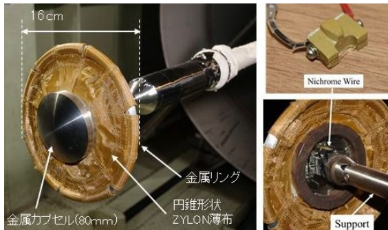
図 4 : エアロシエル分離試験用の模型(左:模型斜め前方からの外観、右:カプセルの背面に搭載されたエアロシエル分離機構)
