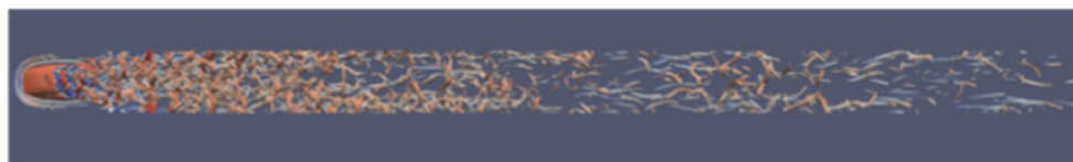
図 3 平板境界層でのスタッド後方での乱流渦
