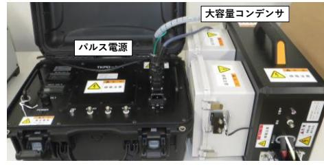
図 1 開発した加振用電磁パルス源
