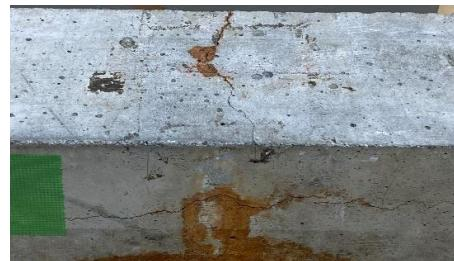
図8 鉄筋腐食評価実験に使用したRC供試体
