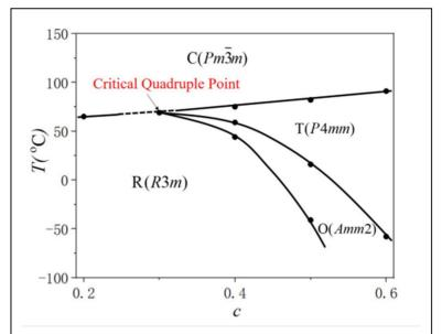
図1 三重臨界点を持つ非鉛圧電材料の状態図。三重臨界点の周囲組成及び温度において高い圧電特性が得られる。
