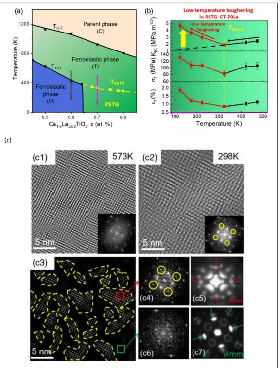
図 4 (a) Re-entrant strain glass 状態図。 (b) Re-entrant strain glass による低温強靭化効果。(c) Re-entrant strain glass のナノ組織
