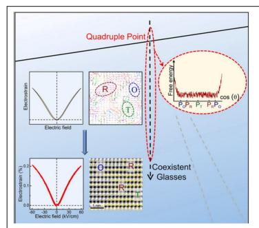
図3 三重臨界点を持つ非鉛圧電材料系に点欠陥の導入によって tri-relaxor 型強誘電体に変わり、この状態において、これまで困難であった大きい電歪効果と小さいヒステリシスを同時に実現できた。
