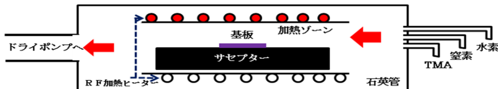
図 1. アンモニアフリー高温有機金属気相成長装置の成膜室部分の概略図
