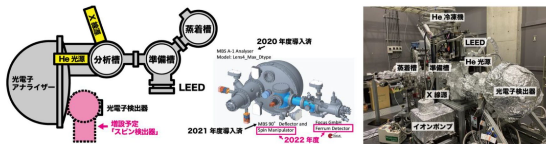
図5 名古屋大学に導入された光電子分光および電子線回折材料評価システム(有機分子仕様)。
