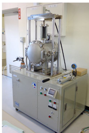
図 1. ホットプレス装置の外観および内部構造
