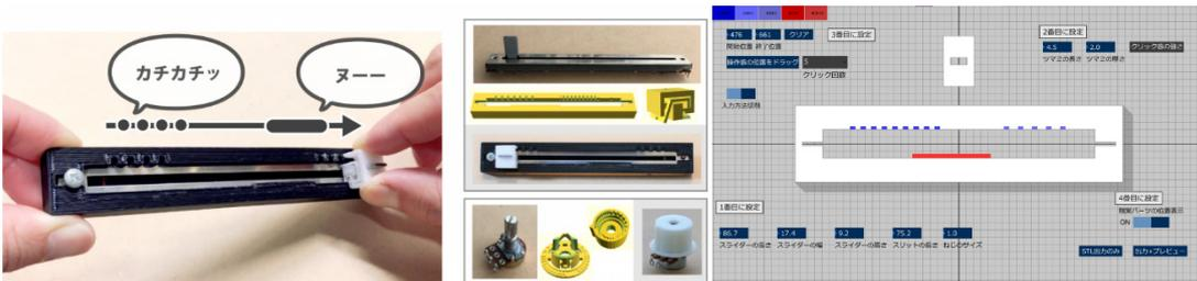
図6. 可変抵抗にクリック感と重みを付与する外骨格機構と設計ツール
