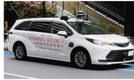
レベル4（特定の条件下でのシステムによる自動運転）を目指した試験車両（米国トヨタ製シエナ1500cc/ハイブリッド）
