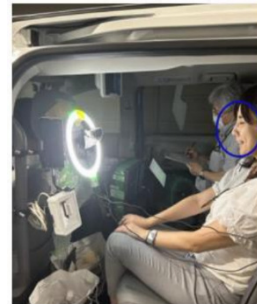
図 4 映像脈波計測用 Web カメラと照明用リングライト
