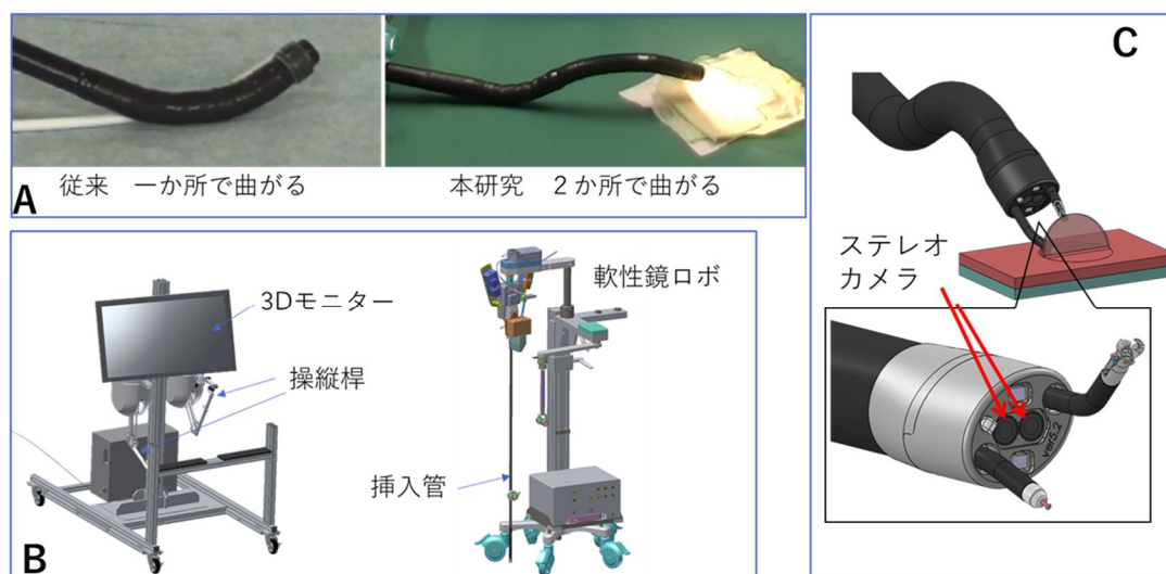
図1 A 屈曲部の改良、B コンソールと内視鏡ロボットの外観、C 内視鏡の先端部とステレオカメラ
