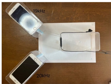
図1 スマートフォンを用いた超音波の干渉実験
