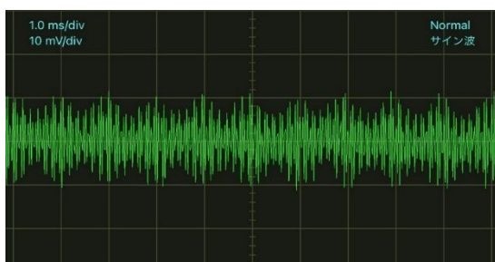
図3 超音波の干渉によって生じたうなり
