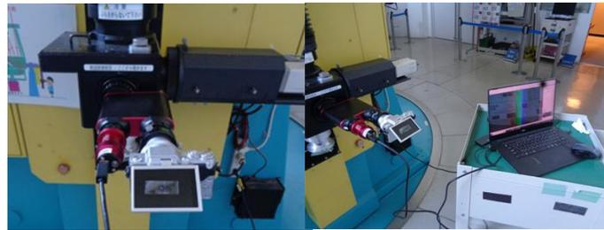
図 1 3 CMOS カメラの取付状況
