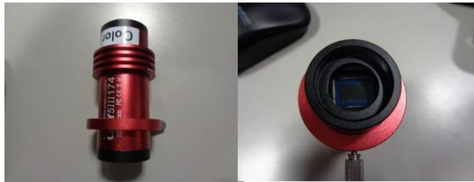
図 1 2 QHYCCD QHY5III 174C(CMOS カメラ)
