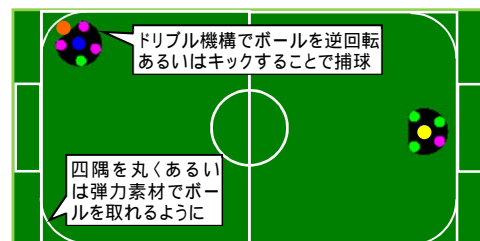
図3 完全自律ロボットの動作と環境
