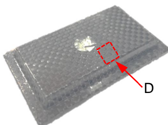
図 11 ポリカーボネートを母材とする CFRTP シート成形品(22.5s)
