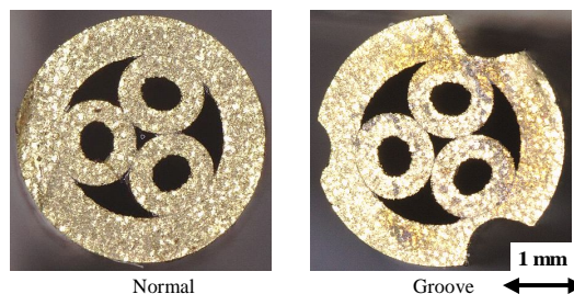
図 1 溝付き有無のパイプ電極断面
