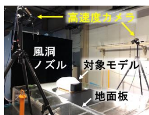
図4 風洞試験セットアップ概観
