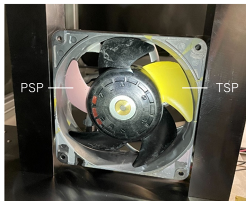
図4 回転体を用いた圧力変動場計測
