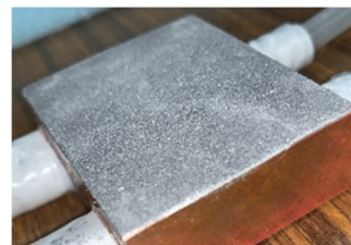
図 4 吸着剤塗布平板の写真
