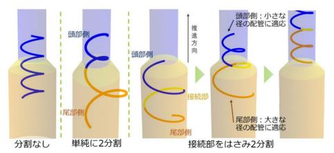
まず,ヘビ型ロボットの形状を頭部側と尾部側で単純に分割すると,図の左側で示すように,頭部側と尾部側で螺旋の中心軸がずれてしまい径の変化する配管を推進するにあたって不適切な形状になってしまう.そのため,ヘビ型ロボットの頭部側と尾部側で形状を分割する際,中心軸を一致させるように連結することが必要である.そこで,ヘビ型ロボットの頭部側と尾部側を接続するための接続部を導入する.ヘビ型ロボットの頭部側,接続部,尾部側に色分けして表示したものを図の右側に示す.なお,接続部の形状を決定するパラメータは幾何学的に求めることができる.
