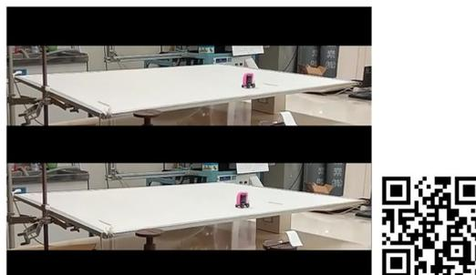
図5 1次元移動体への光無線給電（位置予測なし
