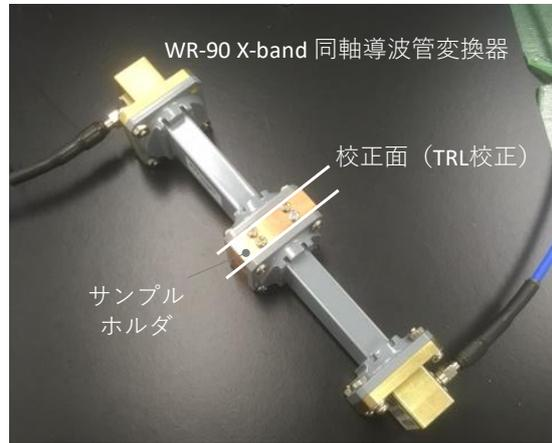
図 10 測定系の概要
